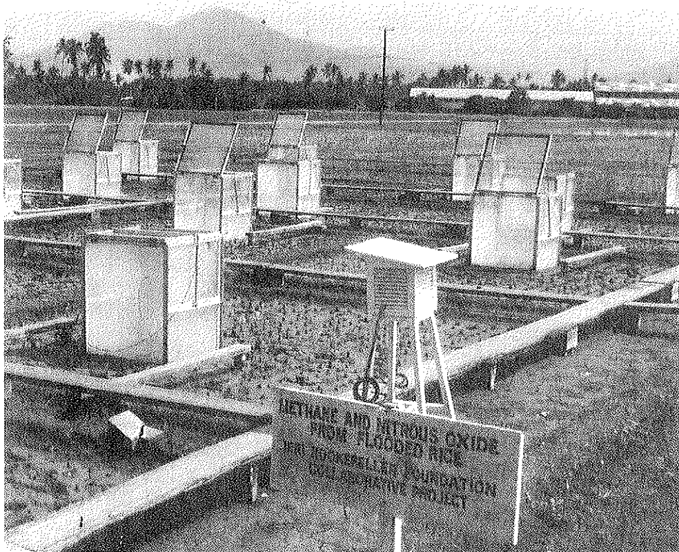
Abb. 1. Vor, nach (im Bild) und während der Reiskultur werden Methan- und Lachgasemissionen aus dem Boden anhand von Gasproben gemessen. Ein Computer steuert das Öffnen und Schliessen der einzelnen Kammern sowie die automatische Probeentnahme. Die Gasproben werden durch ein verlegtes Leitungssystem zur Messeinheit in einem Containerwagen (im Bild nicht sichtbar) geleitet. Dort werden Gasmesswerte sowie Witterungsdaten fortlaufend gesammelt und automatisch verarbeitet.
