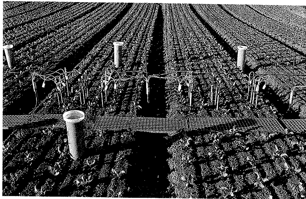
Abb. 6. In verschiedenen Tiefen des Oberbodens wurden mit Tensiometern und Saugkerzen Veränderungen im Wasser- und Nitratgehalt gemessen. Die Niederschläge wurden direkt auf dem Versuchsfelde mit Regenmessern aufgefangen.
