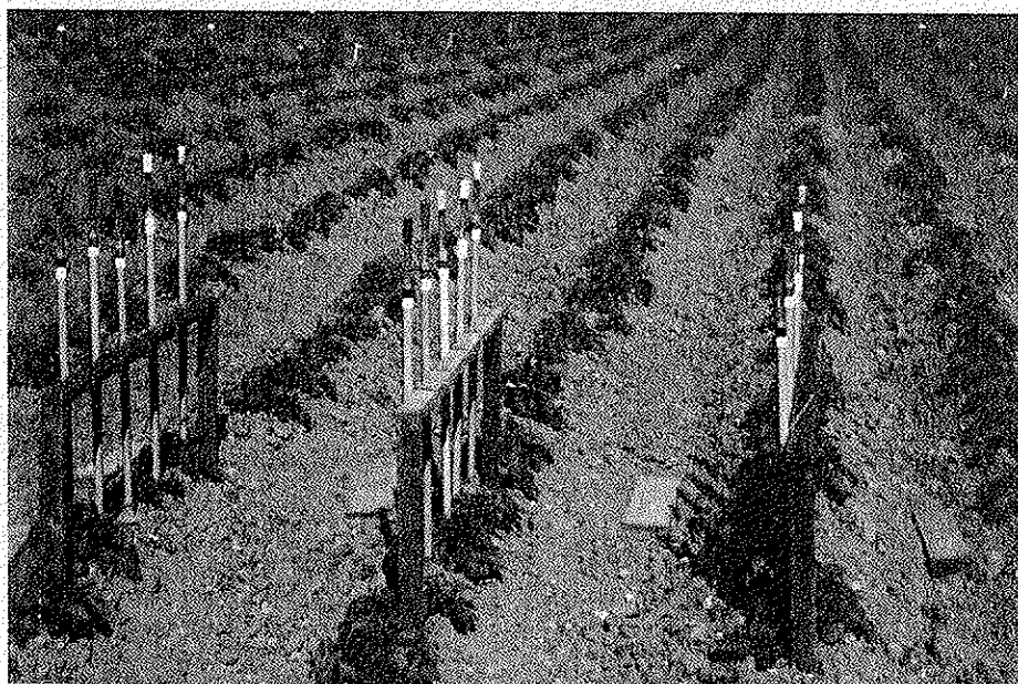
Abb. 5. Die Messung der Bodenfeuchte als Saugspannung des Bodenwassers erfolgt mit Hilfe von Tensiometern jeweils in 15, 30, 45, 60 und 90 cm Bodentiefe; pro Tiefe mit jeweils drei Tensiometern.
