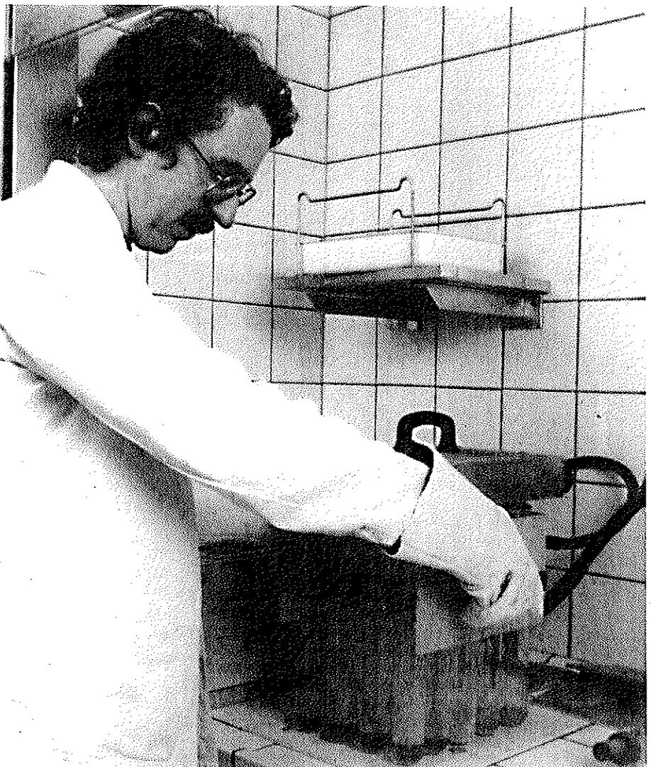
Abb. 1. Für die Bestimmung des Stickstoffgehaltes wird das Probenmaterial mit siedender konzentrierter Schwefelsäure unter Zugabe geeigneter Katalysatoren aufgeschlossen (Foto: Gabriela Brändle, FAP).
