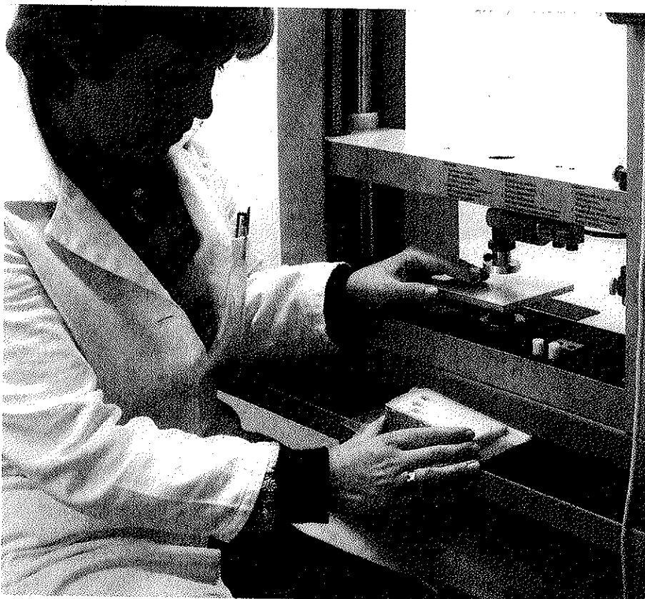
Abb. 4. Universal-Prüfmaschine für die uniaxiale Kompression. (Foto: J. Hättenschwiler, FAM)
