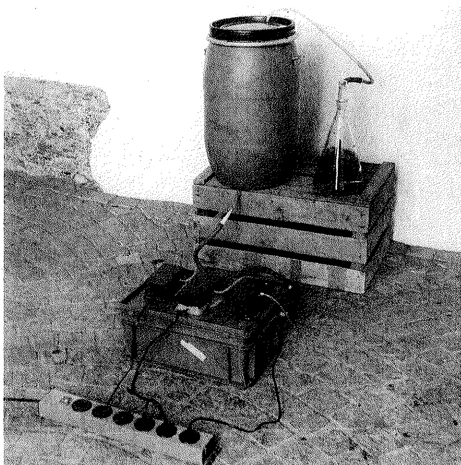
Abb. 1. Aufbau des Bioreaktorsystems. Im Vordergrund am Boden die Ammoniakquelle, aus der mittels der Pumpen das Ammoniak-Luftgemisch in den stehenden Biofilter gefördert wird.
