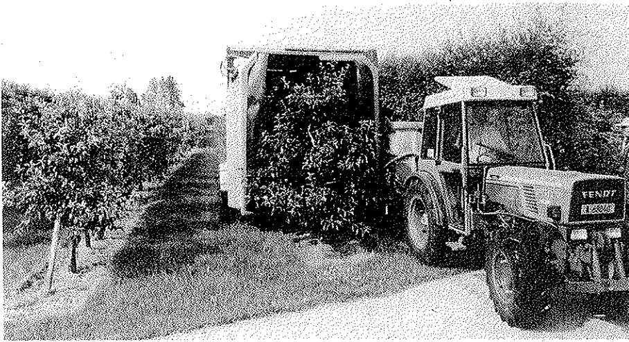
Abb. 5. Beim Tunnel-Recyclingsprüher werden die nicht angelagerten Tropfen am Sumpf der zwei Prallwände gesammelt, filtriert und wieder in den Behälter zurückgesaugt (Joco).
