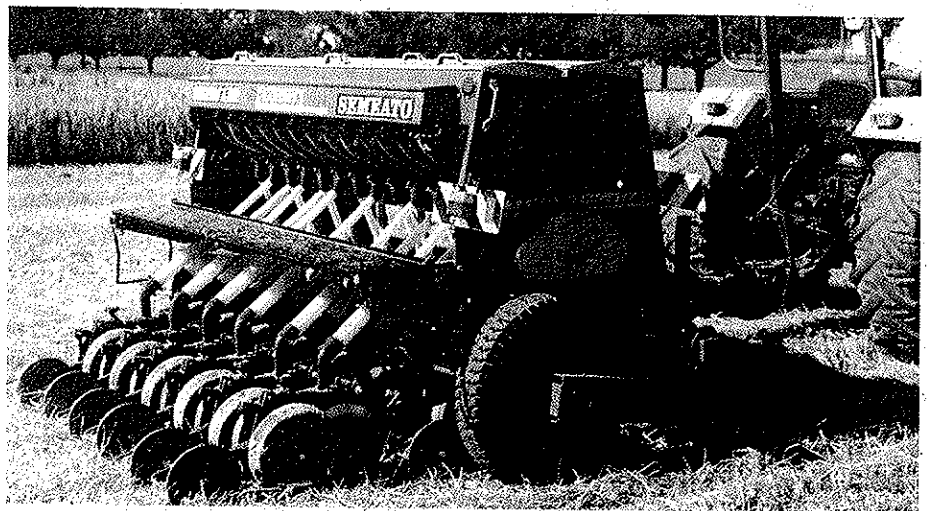
Abb. 1. Symbol der Direktsaat ist die permanente Bodenbedeckung. Der grösste Teil der weltweit über 60 Direktsaat-Fabrikate ist dementsprechend mit Scheibensäscharen ausgerüstet. (Foto: W.G. Sturny, BSF Bern).
