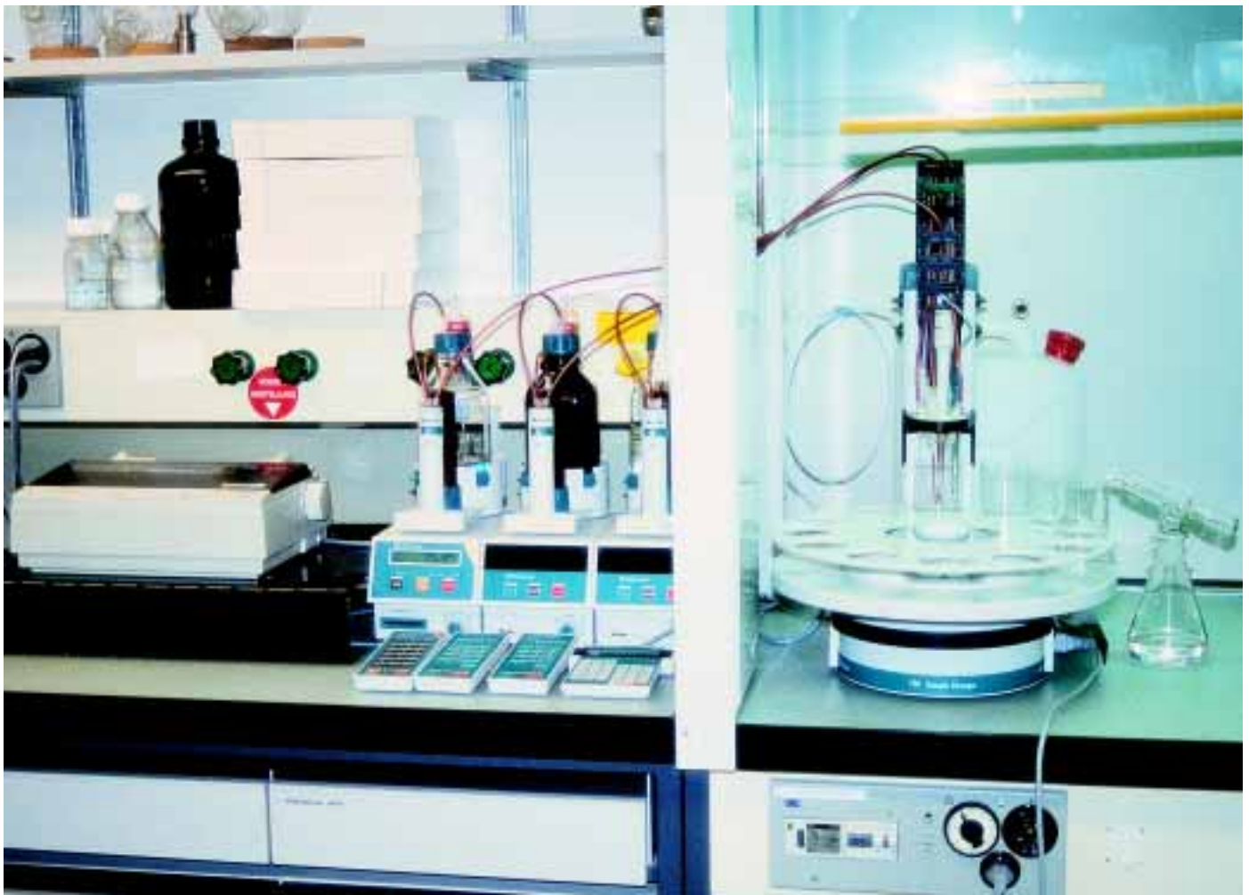
Abb. 8. Das «Fettzahlgerät» - rechts: Probenteller und Haltevorrichtung für Messsonden, Rührer und Bürettenspitzen; mitte: automatische Dosiereinrichtung und Titroprozessor; links: Drucker für Titrationskurven und Messwerte.
