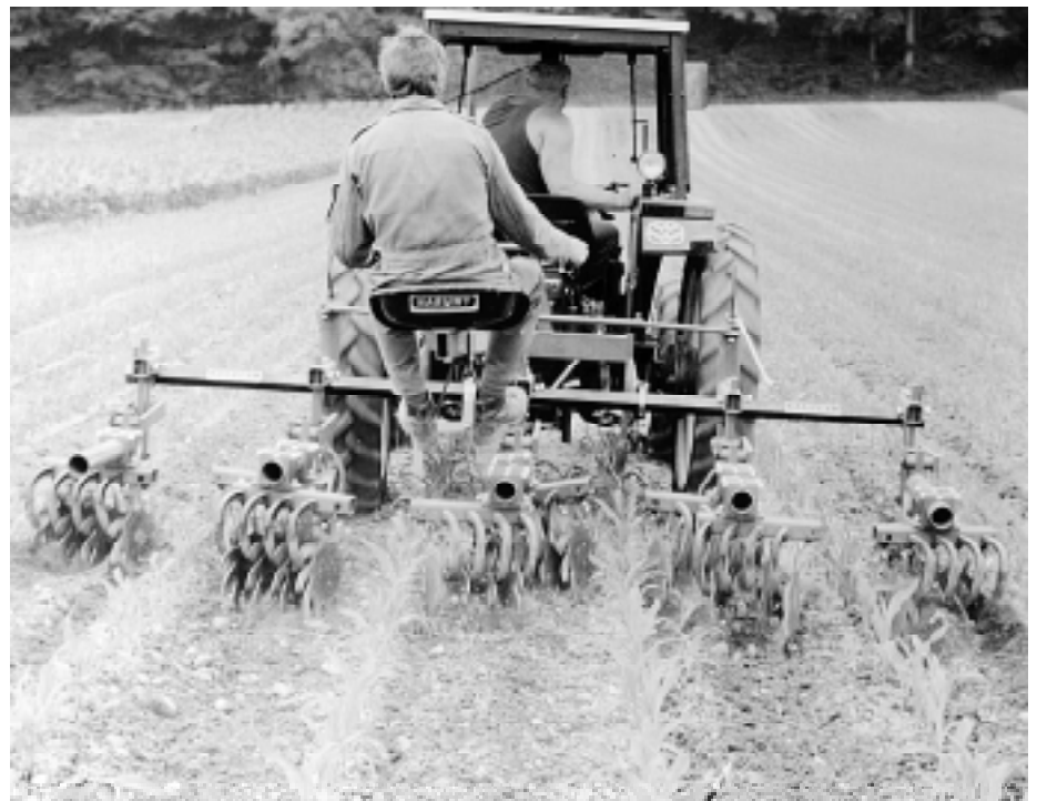
Abb. 1. Für die Unkrautregulierung im Mais reicht ein zweimaliger Einsatz des Sternhackgerätes nach einer Herbizidbandspritzung oder einem Striegeln aus.
