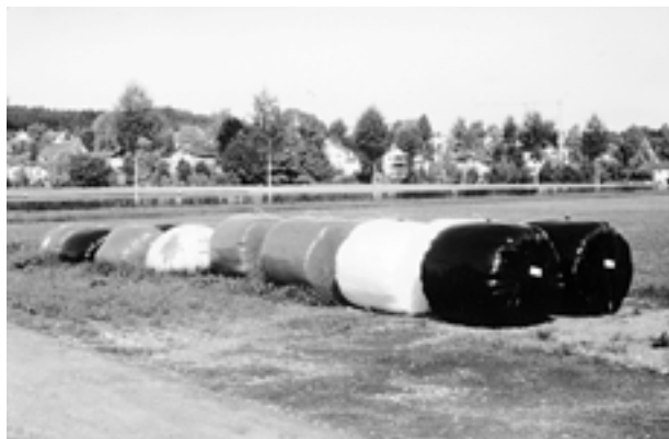
Abb. 1. Versuch mit Silage-Rundballen: Wie verhalten sich farbige PE-Stretchfolien im Vergleich zu weissen und schwarzen Folien? Hinten Ballen vom Mai-Versuch (1. Schnitt), vorne Ballen vom August-Versuch (3. Schnitt).
