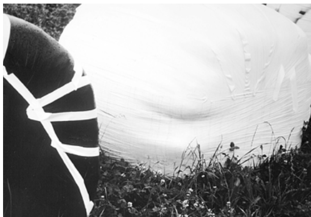
Abb. 1. Silageballen aus biologisch abbaubaren Ecoflex-Folien. Das schwarze Folienmaterial ist mit Russ stabilisiert. Wegen der fehlenden Klebeschicht wurden die Ballen an den Folienüberlappungsstellen mit witterungsbeständigem Klebeband abgedichtet.
