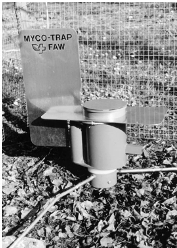
Abb. 4. An der FAW entwickelte Falle (Myco-trap) zur Quantifizierung des Sporenfluges wichtiger Apfel- und Rebenkrankheiten.
