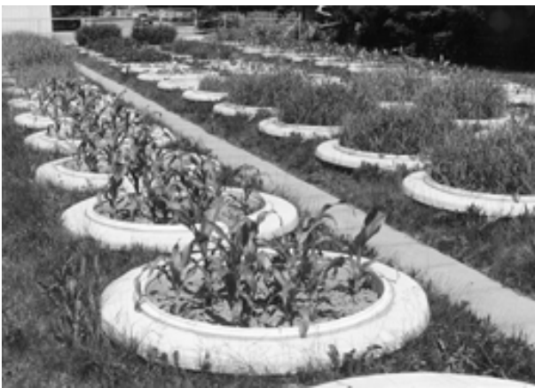
Abb. 1. Lysimeteranlage Liebefeld. Links: Mit verschiedenen Kulturen bepflanzte Gefässe. Rechts: Messinstallation für Sickerwasser und Probenahme.
