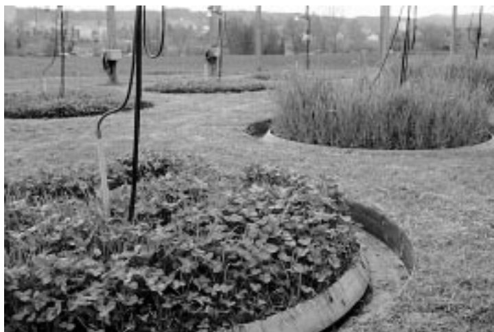
Abb. 1. Kulturart und Düngung beeinflussen die Konzentration von Sulfat im Sickerwasser. Die Lysimeteranlage in Zürich-Reckenholz dient unter anderem zur Prüfung von Fragen des Stofftransportes ins Grundwasser.
