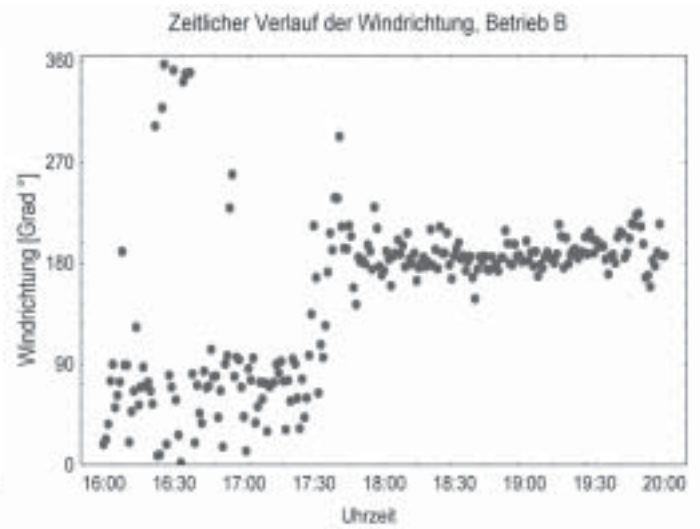
Abb. 3. Verteilung der Windgeschwindigkeit und -richtung am Standort B in der Situation mit und ohne Kaltluftabfluss (links) sowie zeitlicher Verlauf der Windrichtung beim Wechsel zur Situation mit Kaltluftabfluss.
