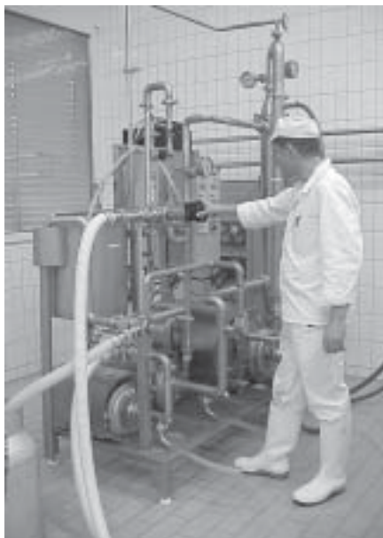
Abb.1. Die Milch wurde mit dieser Mikrofiltrationsanlage aufkonzentriert.
