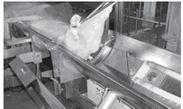
Abb. 2. Autofom-Gerät zur Erfassung des Magerfleischanteils (mit freundlicher Genehmigung der Micarna Bazenheid.)
