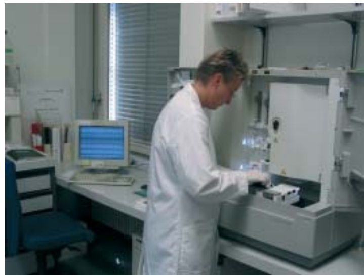
Abb. 5. Die genetischen Fingerprints wurden mit Hilfe eines Kapillar-Sequenzierers angefertigt. (Foto: Roland Kölliker, FAL)
