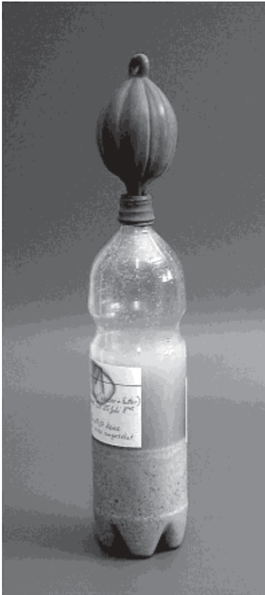
Abb. 5. PET-Flaschentest mit einem Flüssigfutter. Der Ballon ist durch eine leichte Gasbildung etwas aufgebläht.
