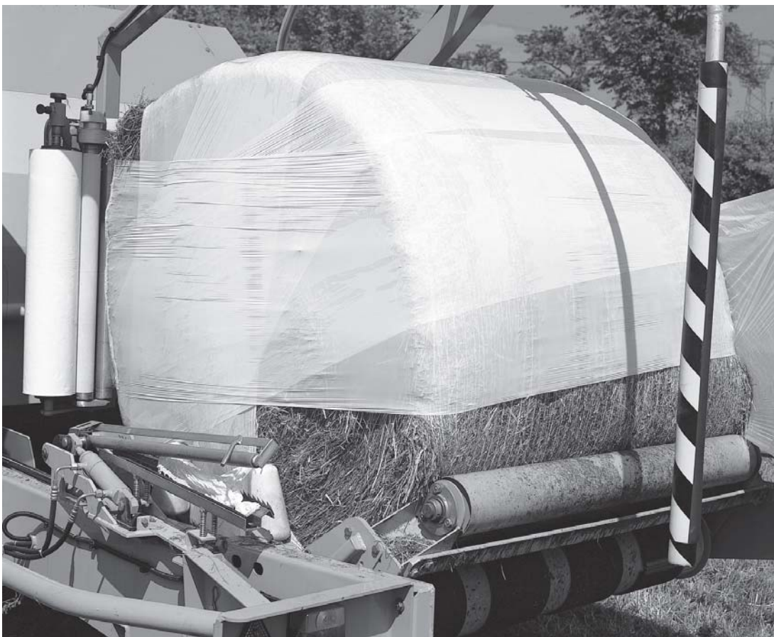
Abb. 5. Der Stretchfolienwickler legt auf die Stirnseite der Ballen mehr Folie pro Ballenoberfläche als auf die Bauchseite (Werkfoto Claas).
