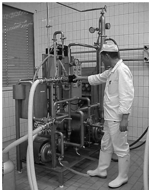
Abb. 2. Kleinanlage von Tetra mit Keramikelementen für ALP-Versuche.
