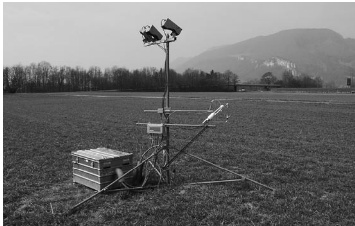
Abb. 2. Messturm zur Bestimmung des CO 2 -Austausches durch die Eddy-Korrelations-Methode. Rechts ist der dreiarmlige Ultraschallgeber zur Bestimmung der Windgeschwindigkeit in drei Dimensionen, davor das weisse Infrarotabsorptionsgerät, welches die Wasserdampf- und CO 2 -Konzentrationen misst. (Foto: Markus Jocher, Agroscope FAL Reckenholz)
