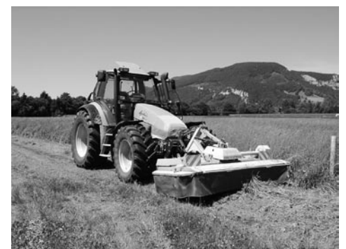
Abb. 5. Mähen des ersten Schnittes der extensiven Wiese: links der Balkenmäher für die Subplots, rechts der Kreiselmäher. (Foto: Albrecht Nefel, Agroscope FAL Reckenholz)
