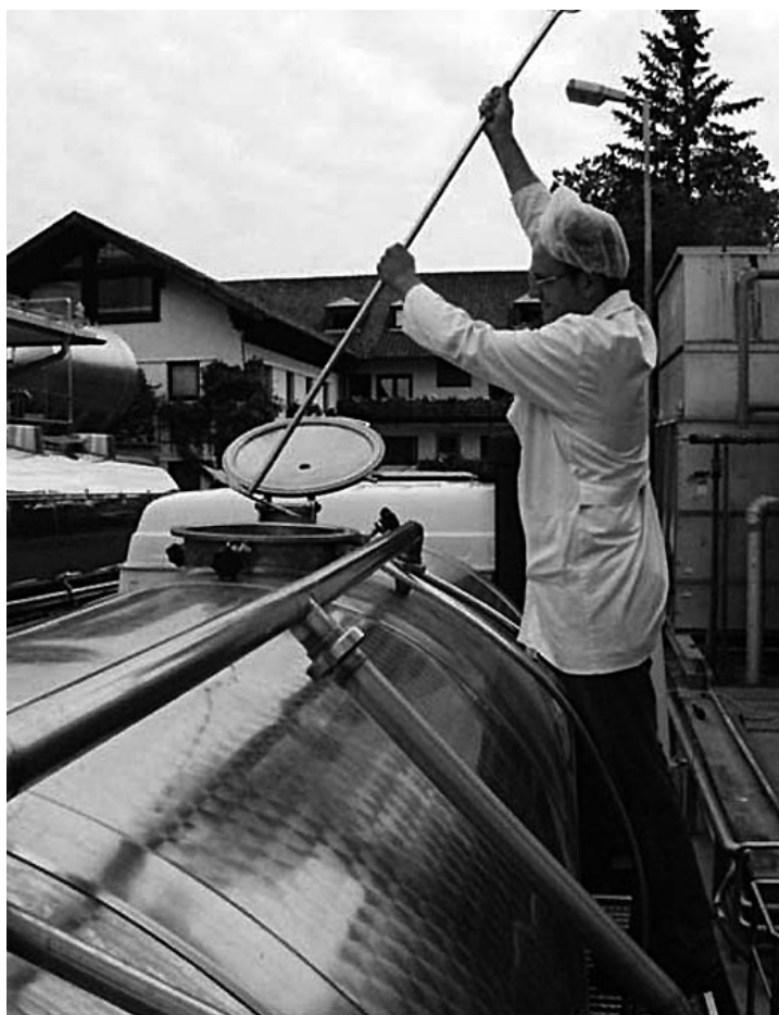
Abb. 2. Manuelles Rühren im Tankwagen (Foto: Zolltechnische Prüfungs- und Lehranstalt München; M. Pabst: Probenahme bei Milcherzeugnissen – Schulungsunterlagen, 2004).
