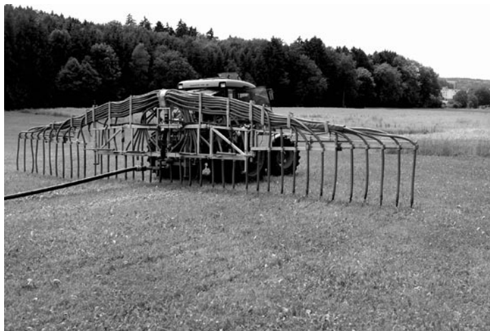
Abb. 6. Das Ausbringen von Gülle mit dem Schleppschlauch hilft die Ammoniakemissionen zu vermeiden. (Foto: Gabriela Brändle, Forschungsanstalt Agroscope Reckenholz-Tänikon ART)
