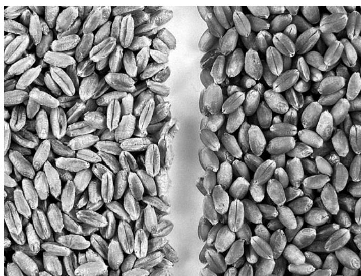
Abb. 2. Das Hektolitergewicht, das dieser Studie zugrunde liegt variiert stark: Links eine Sorte mit 61,9 kg/hl, rechts eine mit 84,3 kg/hl.
