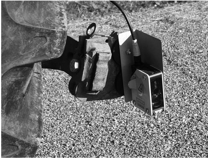
Abb. 7. Kontrolllaser zur Distanzmessung an Anbaugeräteposition im Heck.
