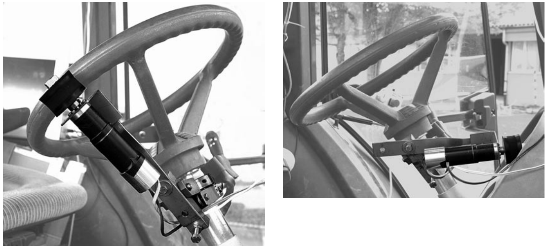
Abb. 3. Lenkantrieb, links Arbeitsstellung, rechts ausgeschaltet.
