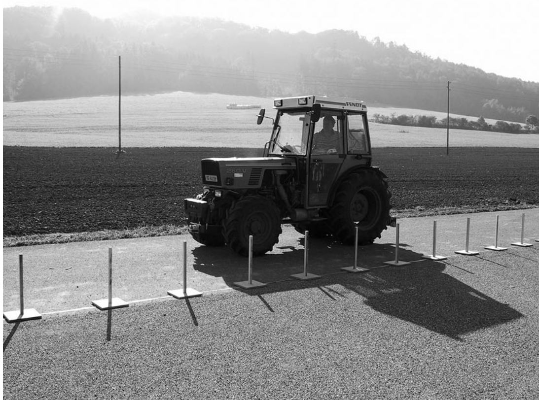
Abb. 6. Messung der Regelgenauigkeit im Versuch mit Holzstöcken für Lasersensor.
