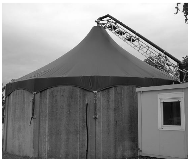
Abb. 1. Versuchsanlage an der ART zur Messung der CH 4 , NH 3 und CO 2 -Emissionen während der Güllelagerung.
