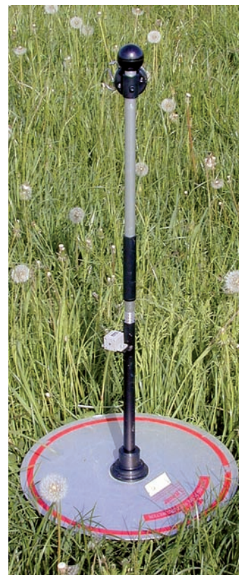
Abb. 1. Herbolometer zur Messung der Grashöhe (neuseeländisches Modell, Jenquip® «Pasture Plate Meter»)
