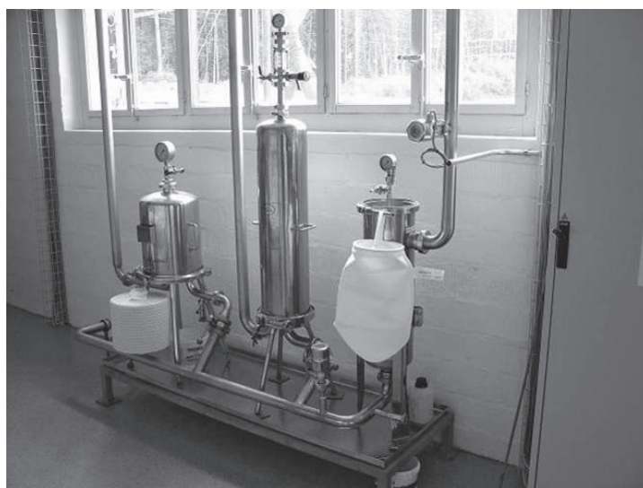
Abb. 5. Fein- und Tiefenfiltration mit Beutefilter rechts, Kerzenfilter Mitte und Modulfiler links, entsprechend der Fliessrichtung des Öls. (Foto: M. Meyer, SHL)
