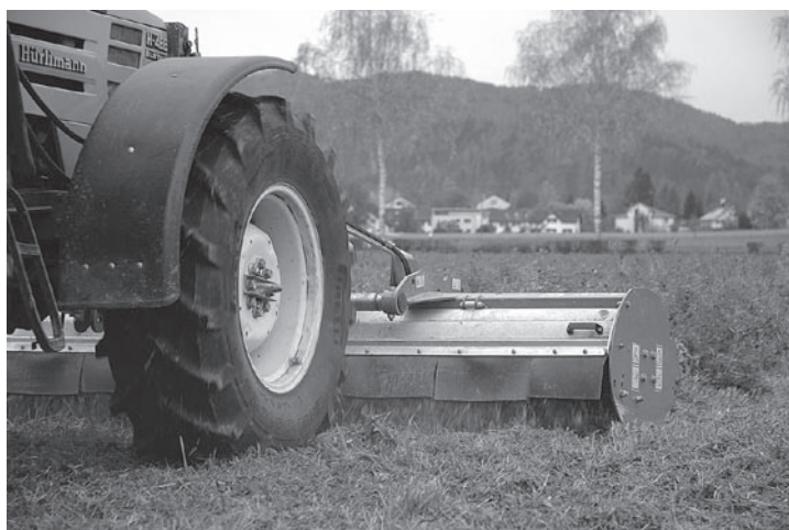
Abb. 2. Mulchen ist bei allen untersuchten Hangneigungen und Parzellengrößen das kostengünstigste Verfahren. (Foto: Joachim Sauter, Agroscope ART)
