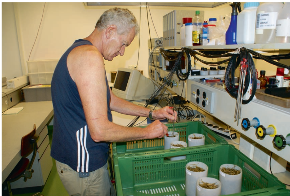
Abb. 2. Vorbereitung der Proben zur Messung der aeroben Stabilität mittels Temperaturmessungen nach der Entnahme. (Foto: U. Wyss, ALP)
