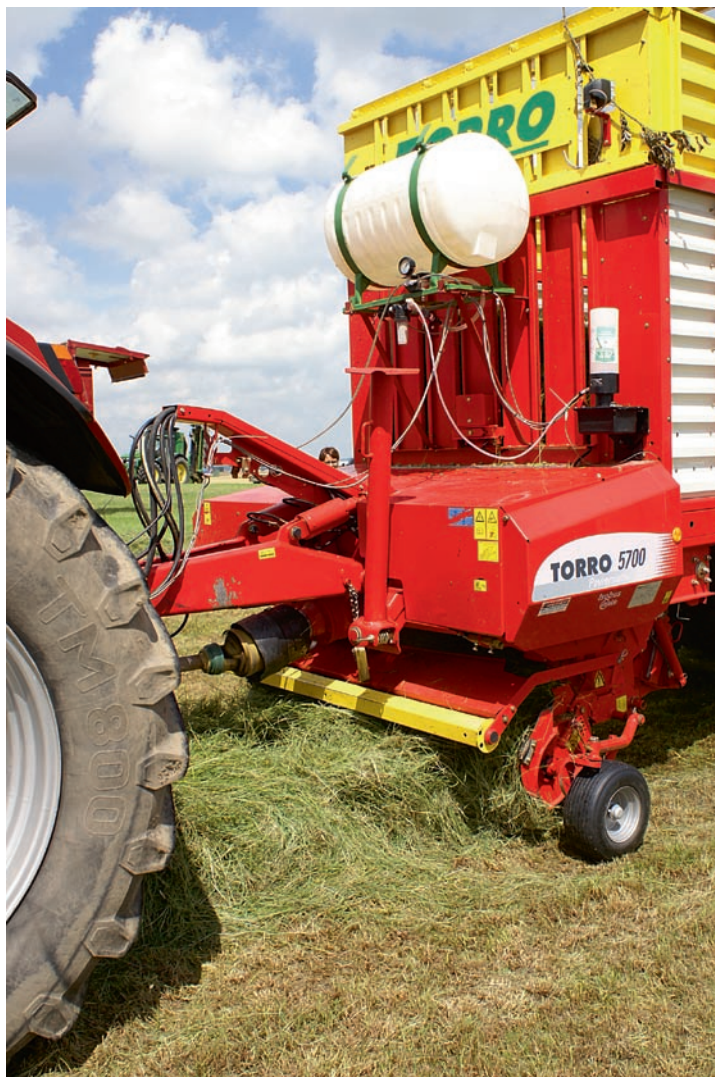
Abb. 1. Eine wichtige Voraussetzung für die Wirksamkeit der Siliermittel ist eine homogene Verteilung mit Hilfe von Dosiergeräten (Foto: U. Wyss, ALP).
