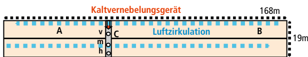
Abb. 7 | Schema der Grundfläche des Gewächshauses mit Tomaten, Versuchsdurchführung in einem Kompartiment mit zwei Schiffen. Eingezeichnet sind: die Position des Kaltvernebelungsgerätes (rot), die durch die Ventilatoren erzeugte Luftzirkulation (blau) sowie die Positionen A, B und C, an welchen Depositionsmessungen durchgeführt wurden (schwarz). Zusätzlich zu den Positionen A, B und C wurden im Durchgang am Boden vorne (v), in der Mitte (m) und hinten (h) auch Depositionsmessungen vorgenommen.
