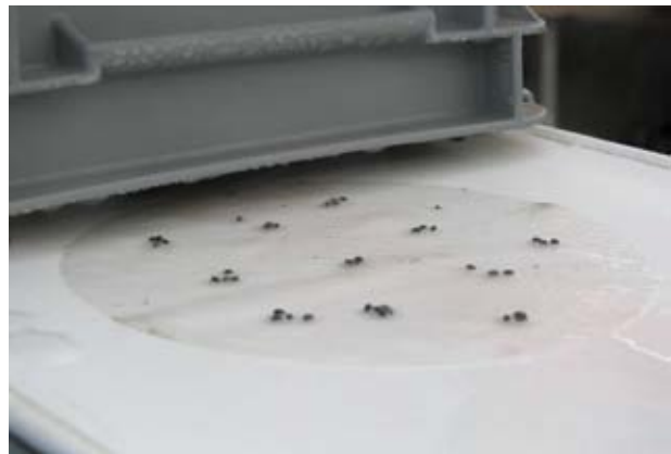
Abb. 3 | Desinfektion von Basilikumsamen auf Filterpapier mit belüftetem Dampf auf dem Förderband der Maschine von ACW. (Foto: C. Zoller, ACW)
