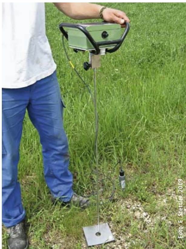
Abb. 3 | Penetrologger der Firma Eijkelkamp Agrisearch Equipment, Giesbeek (NL), mit Tiefenbezugsplatte und Feuchtigkeits-sensor mit Kabel. (Foto: E. Stettler, 2009)
