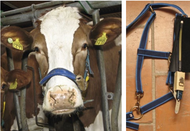
Abb. 1 | Das Mess-Set besteht aus einem Drucksensor und einem Datalogger (MSR145) die in einem Futter und einer Tasche am Nasenband der Halfter untergebracht sind. (Fotos: ART)
