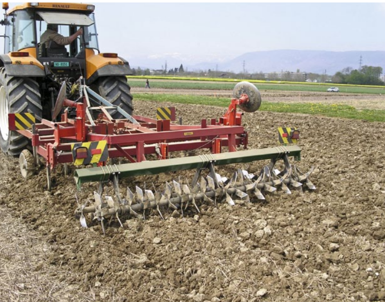
Oberflächliche Bodenbearbeitung mit dem Schälgrubber. (Foto: P. Vullioud)
