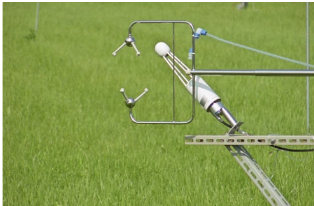
Abb. 4 | Eddy-Kovarianz-System zur Messung der Verdunstung im Feld, bestehend aus einem Ultraschall-Windmesser und einem Infrarot-Sensor für Wasserdampf und CO 2 (weiss). (Foto: ART)
