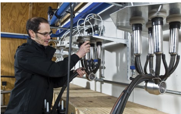
Abb. 1 | Das Forschungsprojekt «Optimierung in der Milchgewinnung» ist in die Forschungsprogramme NutriScope und ProfitLait eingebettet. Es vereint Forschungsgebiete der Technik mit jenen der Tiergesundheit, des Tierverhaltens und der Tierphysiologie. An der Melkwand von ART, welche die Simulation des Melkvorgangs erlaubt, wird tiergerechte Milchgewinnung bei gleichzeitiger Verbesserung der Eutergesundheit erforscht. (Foto: ART)
