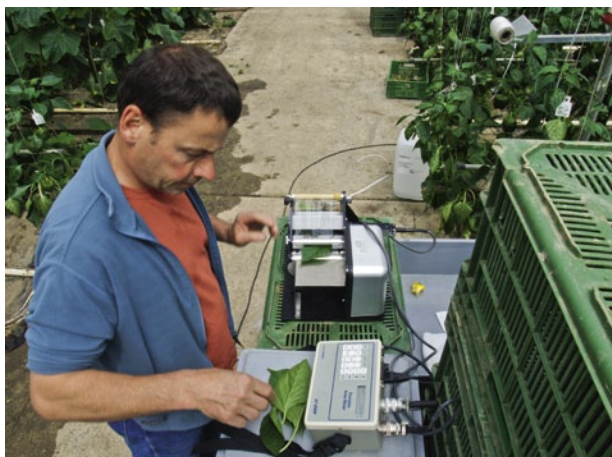
Abb. 3a | Die projizierte Blattfläche einer repräsentativen Anzahl Blätter pro Gemüsepaprika – Pflanze wird mit einem elektronischen, mobilen Blattflächenmessgerät gemessen. Jeder Messzeitpunkt beruht auf einer Stichprobe von zehn Pflanzen.
