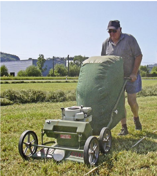
Abb. 2 | Bei den Saugermethoden werden auch organische Pflanzenrückstände – wie z. B. organischer Dünger – als Verluste gewertet. (Foto: ART)
