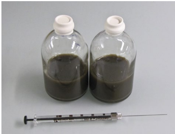
Abb. 2 | Inkubationseinheit mit Entnahmespritze für Gasmessung mittels Gaschromatografie. (Foto: Sabrina Stärfl)
