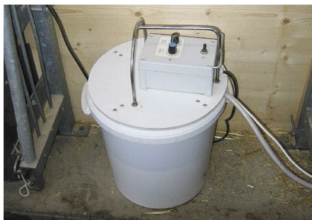
Abb. 1 | Kommerzieller Flüssigfütterungsautomat für Ferkel, der vom Hersteller für die Milchezufütterung modifiziert worden ist. Die mit Wasserstoffperoxid stabilisierte Milch wird in einem geschlossenen Eimer, der ein Rührwerk enthält, aufbewahrt. Die Milch wird durch eine Pumpe angesogen und im Futtertrog mit dem Festfutter gemischt.
