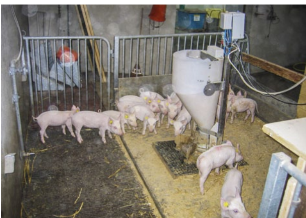
Abb. 1 | Kommerzieller Flüssigfütterungsautomat für Ferkel, der vom Hersteller für die Milchezufütterung modifiziert worden ist. Die mit Wasserstoffperoxid stabilisierte Milch wird in einem geschlossenen Eimer, der ein Rührwerk enthält, aufbewahrt. Die Milch wird durch eine Pumpe angesogen und im Futtertrog mit dem Festfutter gemischt.
