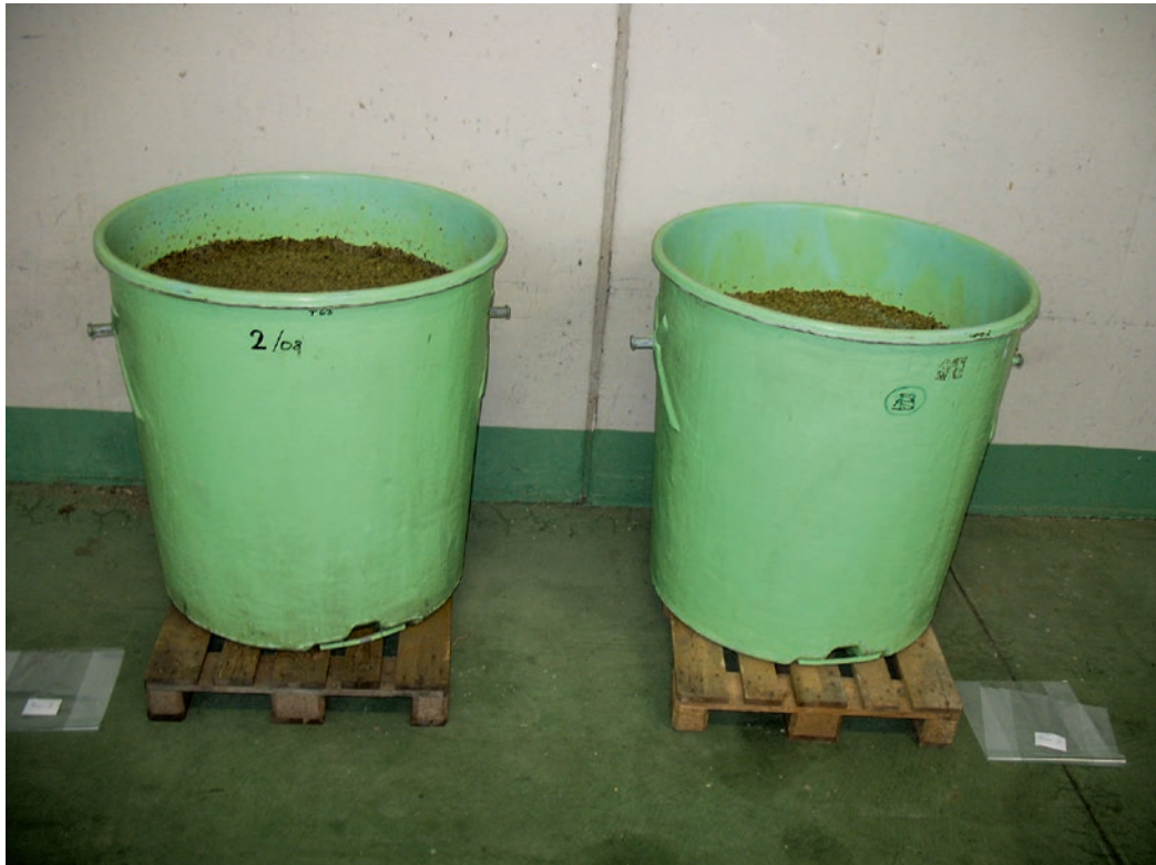
Abb. 3 | Nach einer Lagerdauer von durchschnittlich 118 Tagen wurden die Behälter geöffnet und Proben entnommen.
