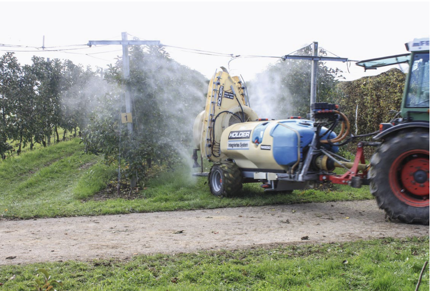
Abb. 1 | Bei jeder Sprühapplikation von Pflanzenschutzmitteln entsteht Abdrift.
