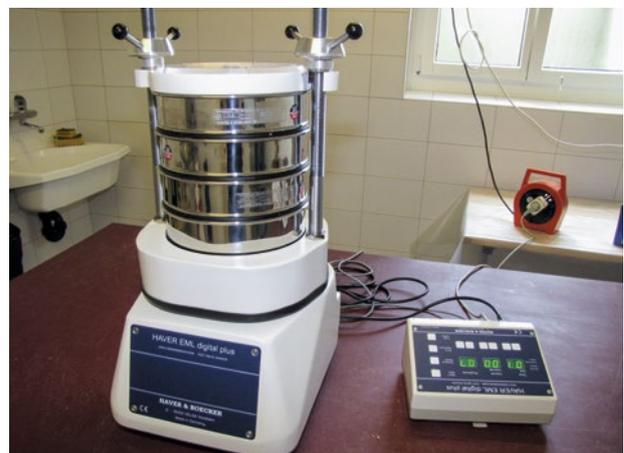
Abb. 2 | Siebanalysengerät von Haver & Boecker. (Foto: Aviforum)
