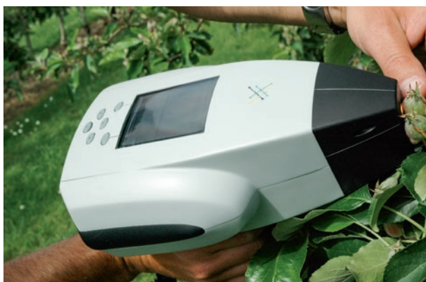
Abb. 2 | NIRS-Gerät im Einsatz. In dieser Studie wurden die Früchte mit dem Reflexions-Spektrometer Phazir (PZ1018, Polychromix) gemessen. Dieses zeichnet NIRS-Spektren im Wellenlängenbereich von 930 bis 1800 nm auf.
