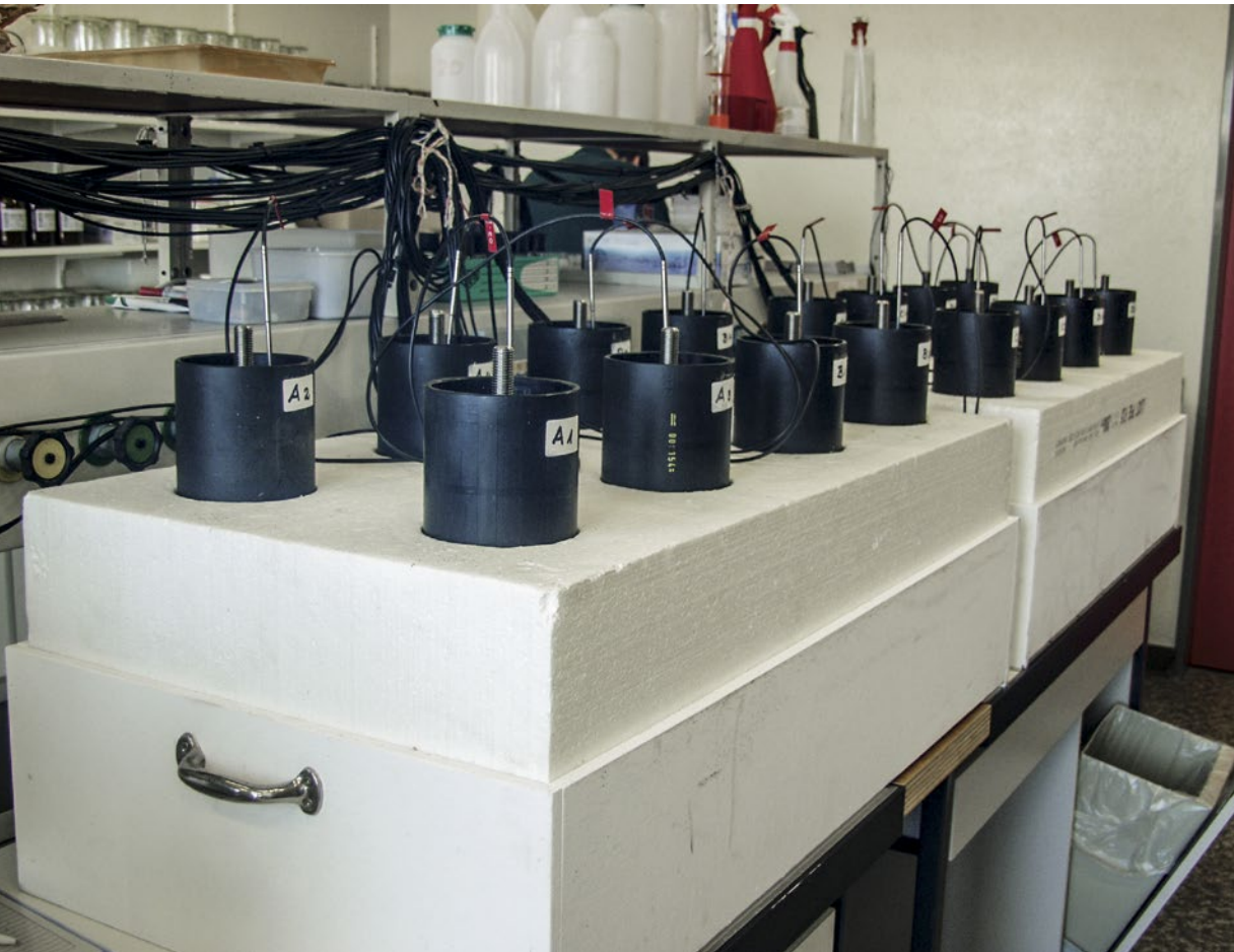
Laborversuchsanlage zur Messung der Erwärmung im Feuchtheu. (Foto: Ueli Wyss, Agroscope)
