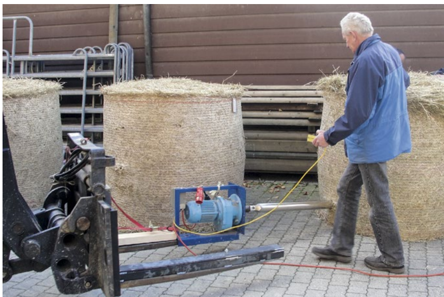
Abb. 1 | Nach einer Lagerdauer von fünf Monaten wurden mit einem Probenbohrer Proben entnommen.
