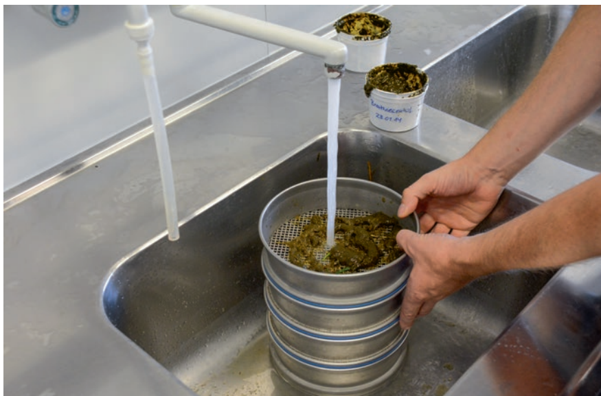
Abb. 2 | Siebwaschung der Kotproben durch vier Siebe mit verschiedenen Porengrößen.
